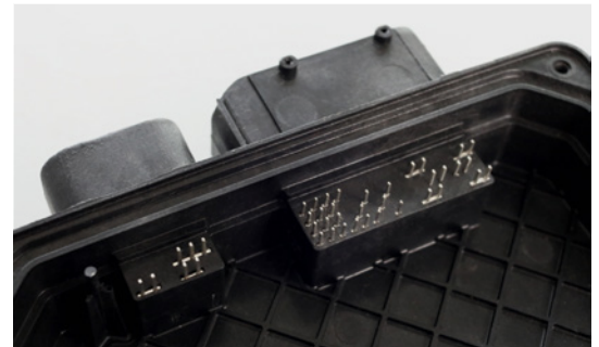
Gehäuse Spritzguss mit Inserttechnik
